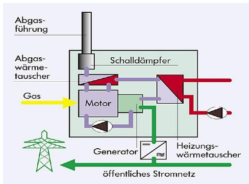
Ein mit Erdgas betriebener Verbrennungsmotor treibt einen Generator an. Dieser erzeugt üblichen Drehstrom (230 / 400V).
